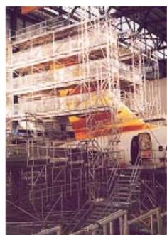
Le système d'échafaudage modulaire pour l'aviation est constitué de section légères en aluminium associées à des pièces en acier galvanisé et de solides roulettes. Ceci permet de fournir des modules extrêmement rigides que l'on peut aisément faire tourner autour de l'appareil.
